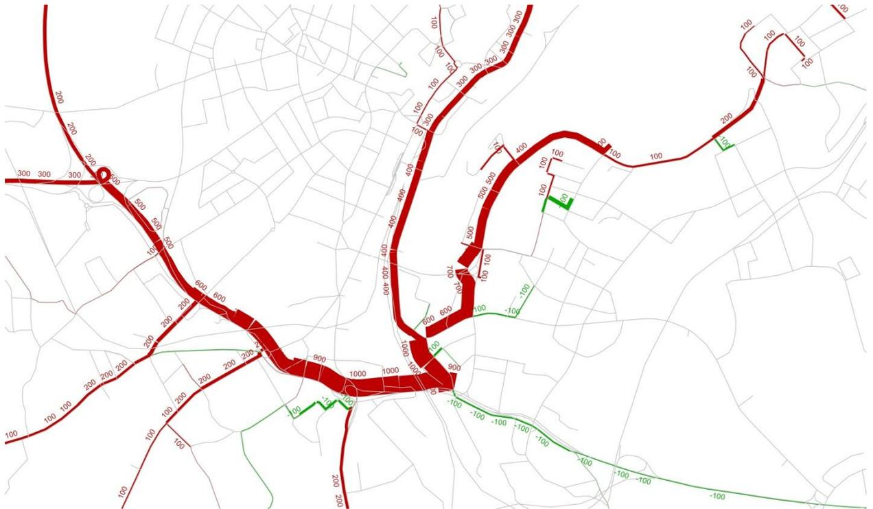
Abb. 15 Differenzspinne am Querschnitt südliche Bahnhofstraße (am Beispiel der Variante A)
