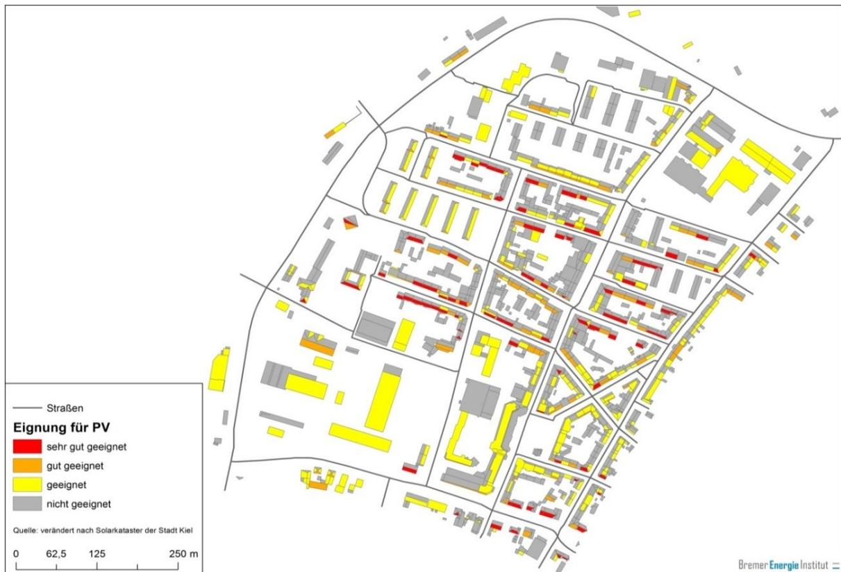
Abb. 18: Eignung von Dachflächen für die Nutzung des Solarpotenzials durch Photovoltaikanlagen zur Stromerzeugung; Quelle: Eigene Darstellung auf Basis des Kieler Solarkatasters
