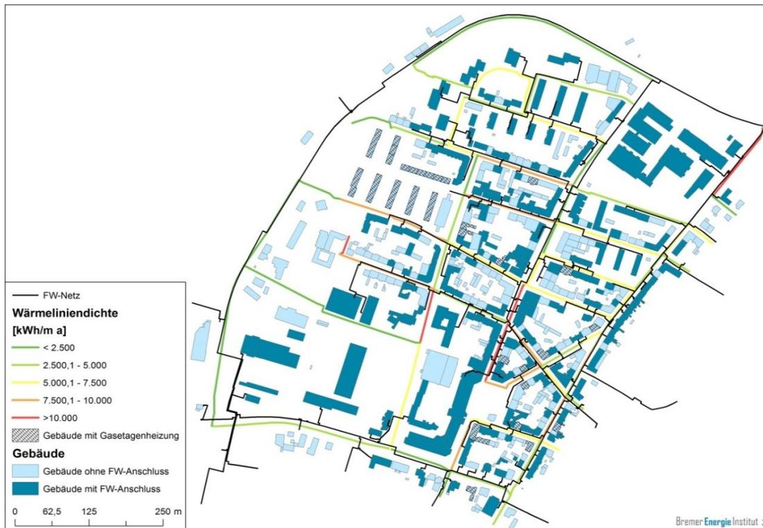
Abb. 25: Wärmeliniedichte in kWh/ma bei Wärmeversorgung aller Gebäude im Quartier über die Fernwärme
