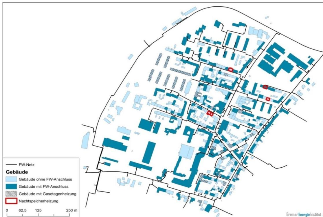
Abb. 15: Karte mit dem Fernwärmenetz, Einfärbung der bereits an die Fernwärme angeschlossenen Gebäude, Hervorhebung der Gasetagenheizungen und Gebäude mit Gasetagenheizungen
