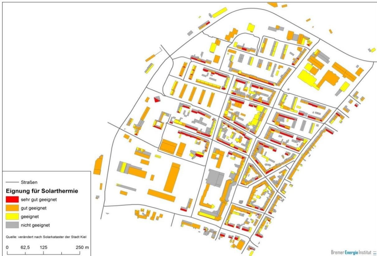
Abb. 17: Eignung von Dachflächen für die Nutzung des Solarpotenzials durch thermische Solaranlagen zur Wärmeerzeugung; Quelle: Eigene Darstellung auf Basis des Kieler Solarkatasters
