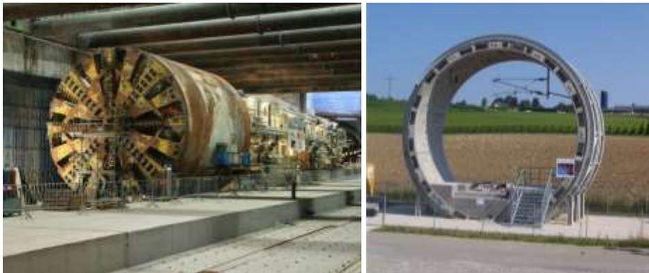
Abb.86 Tunnelbohrmaschine (TBM) und Querschnitt einer eingeleisigen Röhre (Quelle: wikipedia)
